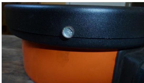
Рисунок 3 – Место пломбировки от несанкционированного доступа
